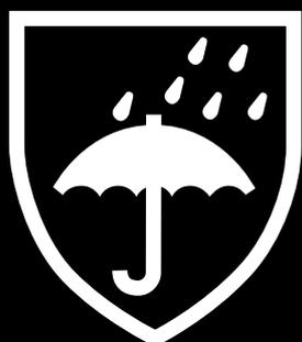
Voici les valeurs les plus importantes : la résistance à la pénétration de l'eau (étanchéité à l'eau) et la résistance à la pénétration de la vapeur d'eau. Ces valeurs sont mesurées sur les matériaux utilisés et sur les coutures. Il en résulte la classe dans laquelle le vêtement est classé. Ce vêtement porte le symbole de la protection contre les intempéries, suivi du numéro de la norme et des classes correspondantes.
