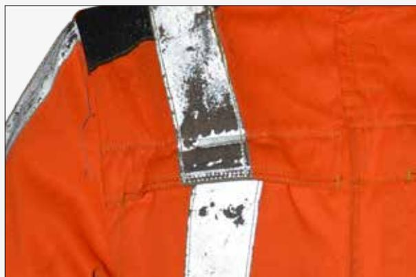
✘ Détérioration du matériau réfléchissant par action mécanique.
