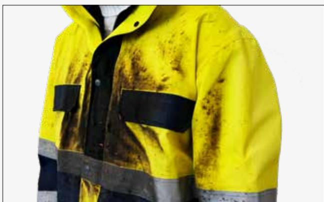
✘ Exemple des effets de l'action thermique après un accident d'arc électrique.
