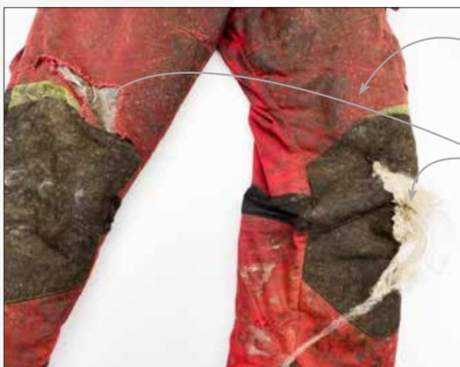
✘ Une contamination extrême par la résine et l'huile peut déstabiliser la doublure de protection anti-coupure.
