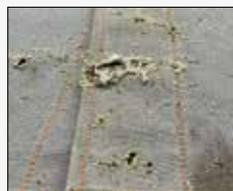
✘ Coloration rouge brunâtre due à une forte exposition permanente aux déchets de soudure.
